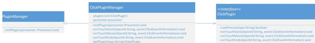
Abbildung 5.3: Klassendiagramm des ClickPlugins
